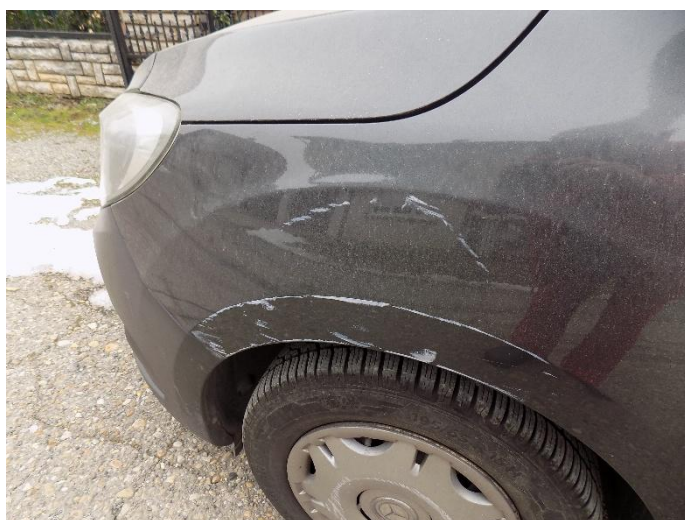
5. Mercedes Citan – oštećenje blatobrana lijevog
