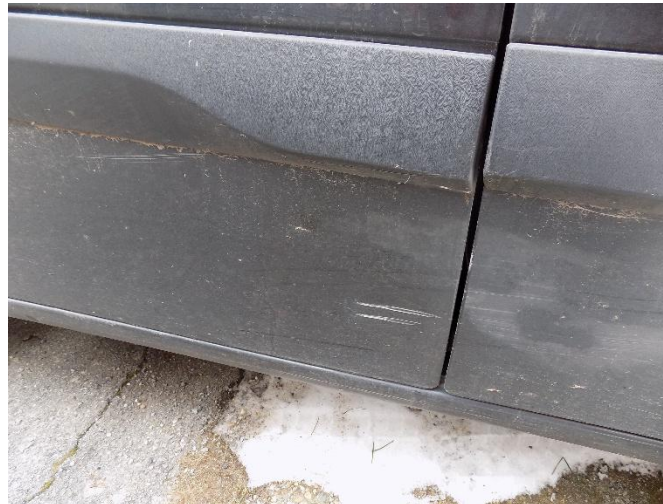
4. Mercedes Citan – oštećenje vrata desnih
