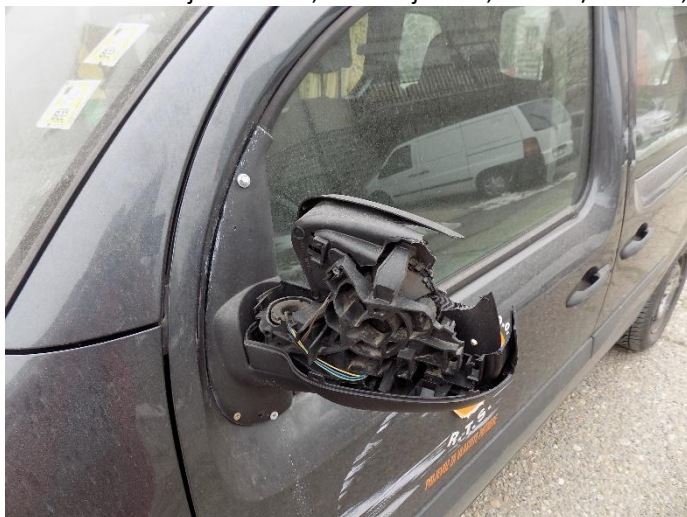
7. Mercedes Citan oštećenje retrovizora
