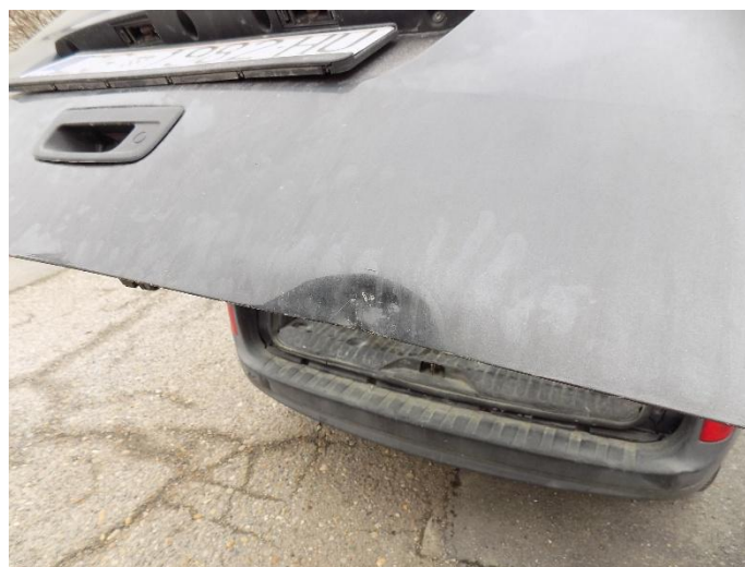
6. Mercedes Citan – oštećenje vrata zadnjih
