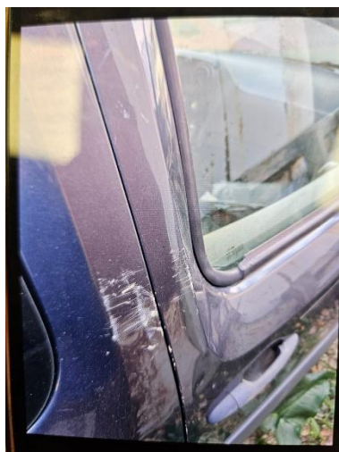
3. Mercedes Citan - oštećenje desne strane
